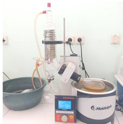
Keringkan dengan rotary evaporator dan gas N 2
